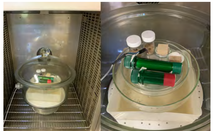
Teil des Versuchsaufbaus zur Letaltemperatur-Bestimmung für Anobium punctatum , Lyctus brunneus , Ctenolepisma longicaudatum und Tineola bisselliella . Heizschrank mit Exsikkator. Rechts die Insektenproben in Plastikgefäßen. Foto: MPA
