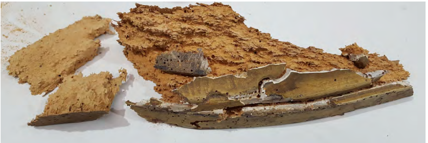
Drastischer Substanzverlust durch Anobium punctatum -Befall, Teile eines Prozessionsthrons, vergoldet und gefaßt, 19. Jh. Foto: ICM Europe
