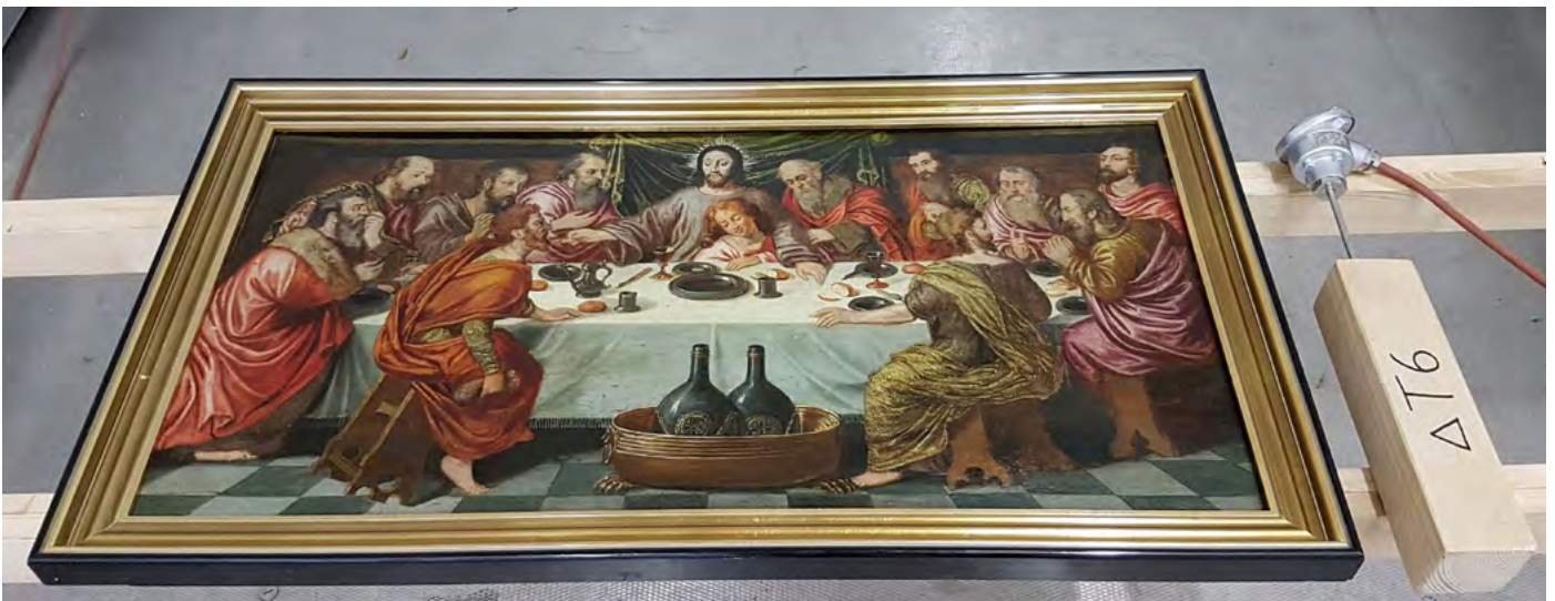
Nachfolger von Pieter Coecke van Aelst, Ende 16. Jh. Rechts der sog. Referenzblock, der die Kerntemperatur mißt. Foto: ICM Europe, Klimakammer Brüssel
