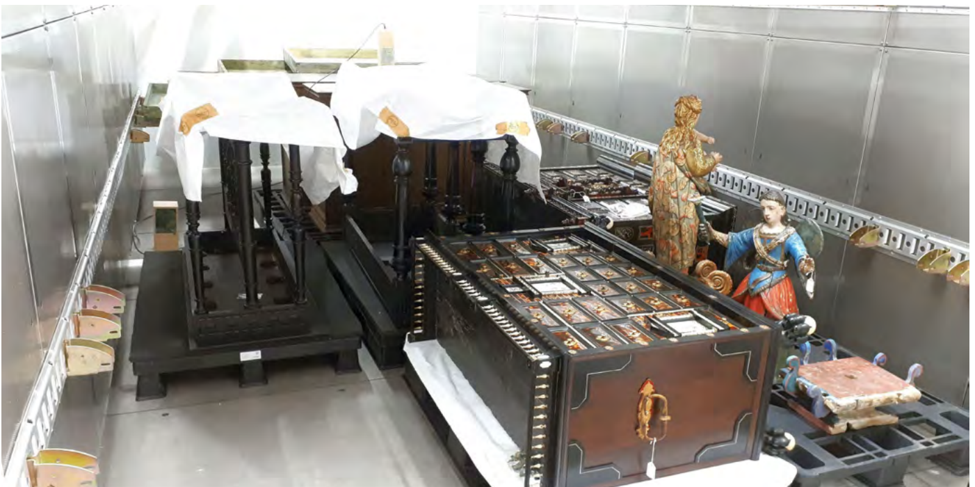
40 m 3 große ICM Kammer in Brüssel. Behandlung von zwei insektenbefallenen flämischen Kabinettschränken, Holz mit Schildpatt furniert, eingelegtes und massives Elfenbein, feuervergoldete Messingbeschläge. Daneben zwei gefasste Skulpturen. Foto: ICM Europe
